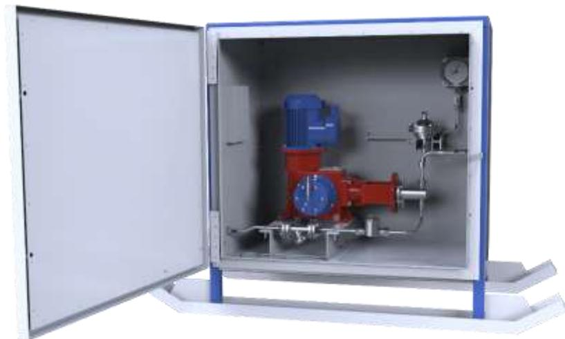
Блок дозирования состоит из металлического корпуса, в котором размещены электронасосный агрегат с системой герметизации утечек, шкаф управления взрывозащищенного исполнения, электроконтактный манометр, обратный клапан, фильтр тонкой очистки, рукав высокого давления.
